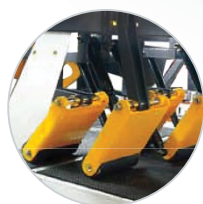
rolki podawcze z dociskiem infeed pressure rollers
