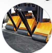
rolki odbiorcze z dociskiem outfeed pressure rollers
